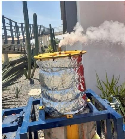
**Figura 48.** Corrida 1 con uso de aislante térmico de fibra de vidrio.
