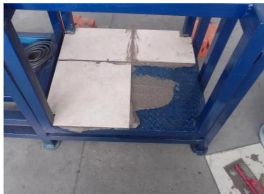
**Figura 41.** Montaje de cama refractaria: aislante cerámico inferior.
