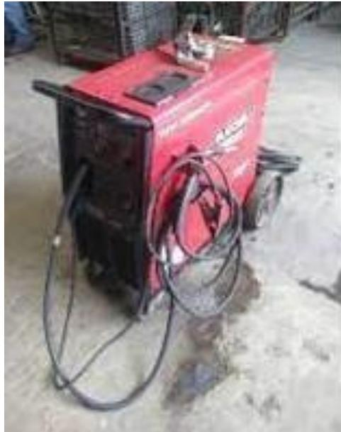
**Figura 16.** Maquina de soldadura de Micro alambre.
