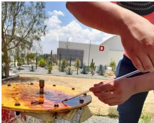
**Figura 51.** Recolecta de la condensación de combustible en la tapa superior.
