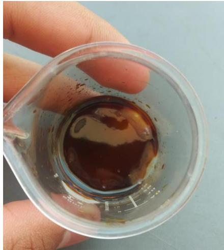
**Figura 52.** Condensación de combustible.
