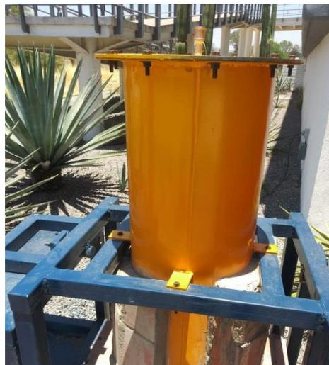
**Figura 53.** Corrida 2 sin uso de aislante térmico de fibra de vidrio.
