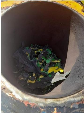
**Figura 44.** Llenado del reactor con material.
