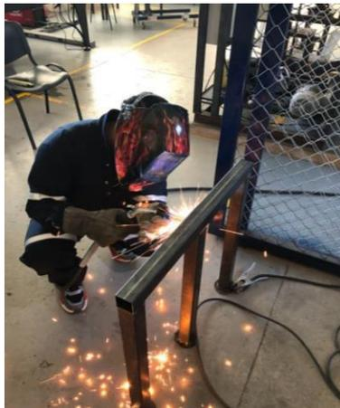
**Figura 31.** Soldadura para soporte de reactor.
