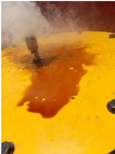
**Figura 50.** Condensación de combustible en la tapa superior.
