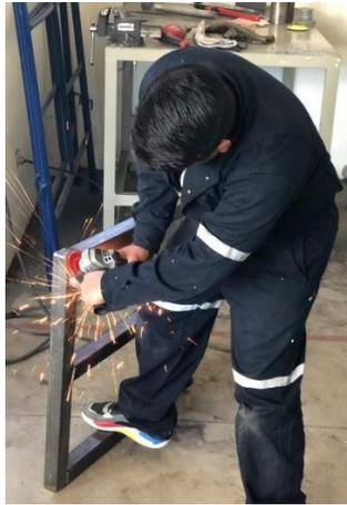
**Figura 36.** Pulido de soporte de porta reactor.
