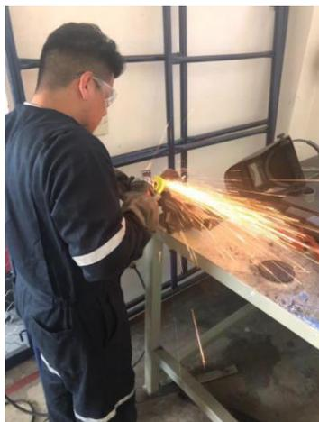
**Figura 35.** Pulido de soldadura.
